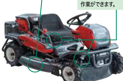
Wウィングカバー仕様により、どちら側からでも刈刃のメンテナンスが可能!
