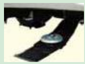
フリーナイフ搭載により駆動系へのダメージを緩和します。
